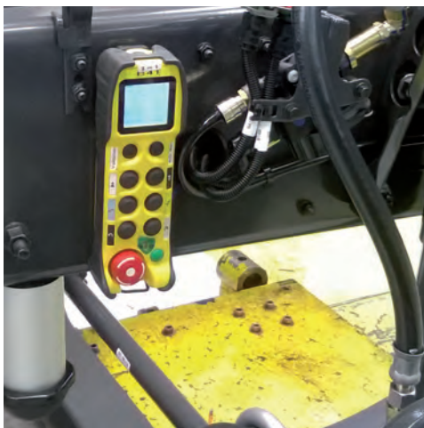
Emetteur Beta prêt à l'emploi sur un engin mobile
