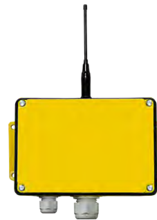
Répéteur pour les situations défavorables telles que les entrepôts fortement encombrés
